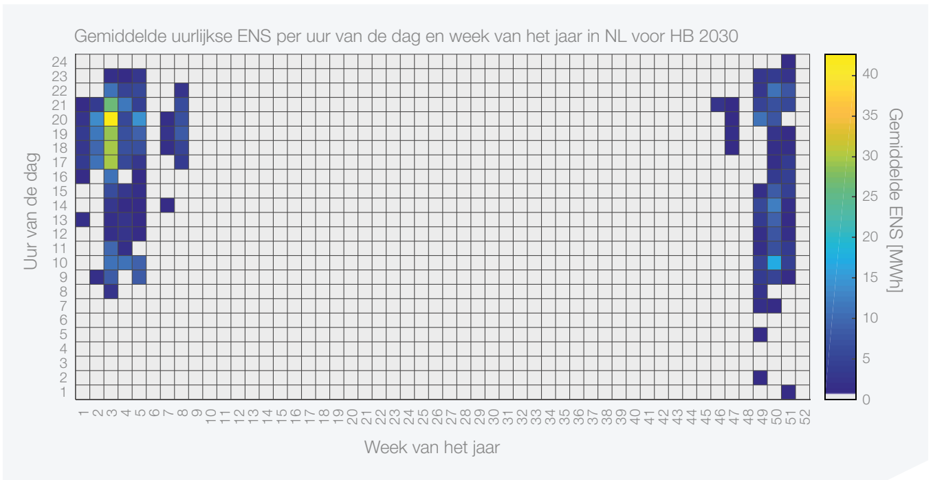
Figuur 4-3: Heatmap van gemiddelde ENS waarden voor de week van het jaar (x-as) en het uur van de dag (y-as). De kleurenschaal geeft de gemiddelde uurlijkse ENS aan in dit type uren in MWh.
